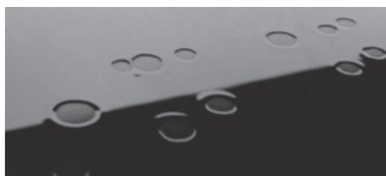
圖 2-1-26：可以用含聚矽氧烷之流平劑消除塗層凹坑
