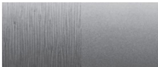
圖 2-1-25：無流平劑的透明塗層（左）和添加改性矽氧烷流平劑的差異（右）
