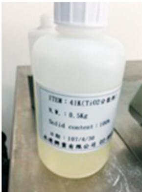
圖 2-1-8：奈米級氧化鈦 (TiO<sub>2</sub>) 專用分散劑
