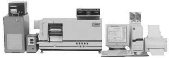
圖三、數位式動態抗分裂力測試儀 (Inkoscope)
