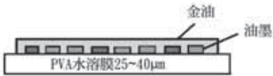
圖四、水轉印膜的結構
