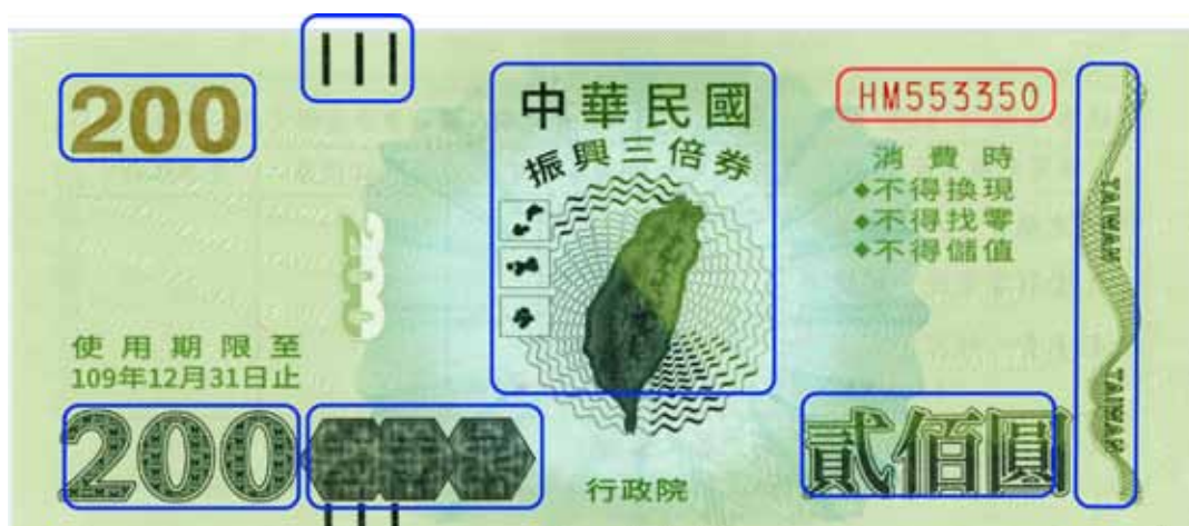
圖 5：振興三倍券面額 200 元印刷組成示意圖。 藍色框處為凹版印刷；紅色框處為凸版印刷；其他底紋為平凸版印刷
