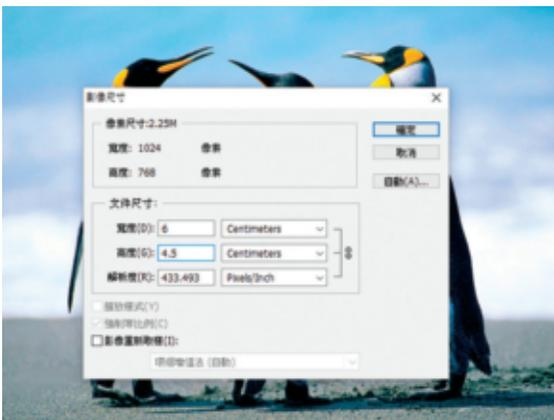
圖 30：直接將文件尺寸改為寬度 6cm，不勾選影像重新取樣以維持檔案為 2.25M，由於文件尺寸變小了，相對的解析度提高至 433 ppi。
