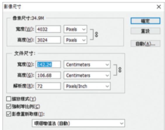
圖 25：手機攝得的數位影像資訊，解析度為 72 ppi，整張影像的畫像元素高達 4032 X 3024 約千萬畫素的畫質。
