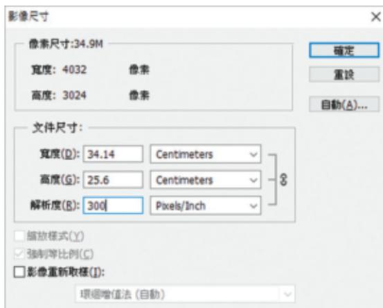
圖 28：從手機拍攝的數位影像原本解析度為 72 ppi，將其調整為 300 ppi，且維持檔案資訊量不變，不經由【影像重新取樣】的情況下，文件尺寸仍比 A4 還大，表示此檔案可以製作成 A4 大小的影像，並以 150 LPI 的線數印製。但是，是否在製作檔案時需要強制改為 300 ppi 的解析度呢？答案是否定的，可直接以原本解析度 72 ppi 的原始檔案編排於 A4 的版面上。
