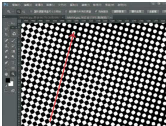
圖 22：之前已設定了 45 度的角度，下一個色版的角度必須隔開 30 度才能產生美麗且均勻的網花結構。依著箭頭的方向可以看出 15 度的網點結構。
