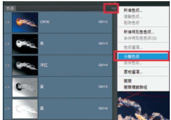
圖 13：將 CMYK 4 個色版分離後，即將模擬每個色版的過網條件。
