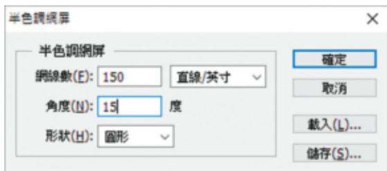
圖 21：之前已設定了 45 度的角度，下一個色版的角度必須隔開 30 度才能產生美麗且均勻的網花結構。
