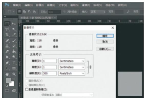
圖 3：解析度 300 ppi (Pixels Per Inch) 的影像資訊
