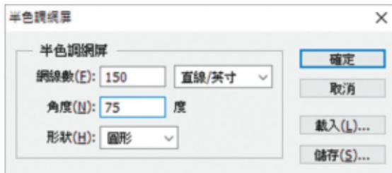
圖 23：之前已設定了 45 度及 15 度的角度，下一個色版的角度必須隔開 30 度才能產生美麗且均勻的網花結構。
