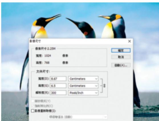
圖 27：將原本解析度是 96 ppi 的檔案，不經過【影像重新取樣】的過程，直接調整解析度為 300 ppi，此時的檔案大小仍為 2.25M，但相對的文件尺寸縮小為 8.67 X 6.5 cm。此條件表示調整為 300 ppi 時的文件尺寸是適合於 150 LPI 的印刷品。
