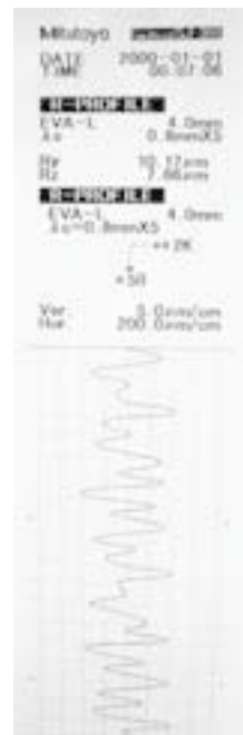
圖20、Rz示意圖表 （資料來源：倉和公司提供測試）
