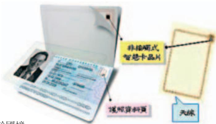
圖 (七) 圖解 ePassport 基本結構
