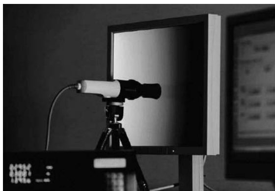
圖十一、每個 EIZO 的螢幕在出廠前都會經由量測儀器測量、並加以調整。而在實際過程應該是黑色的環境，此圖為說明用。
